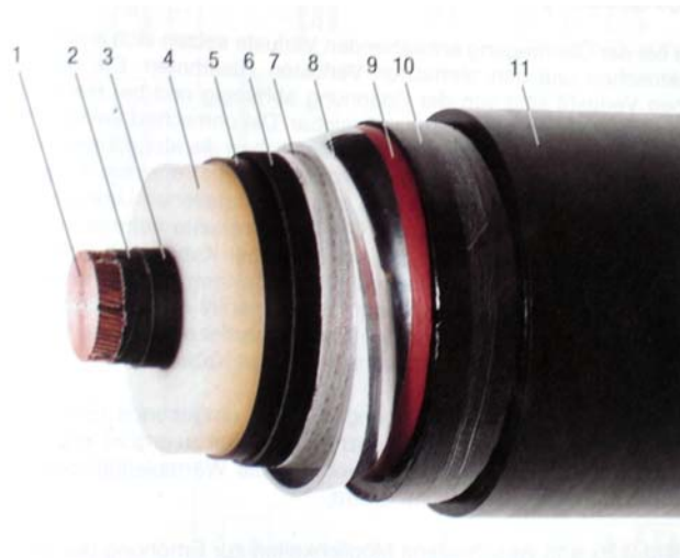
Bild 2: Einadriges VPE-Kabel für 400 kV (Quelle VDEW Kabelhandbuch)
